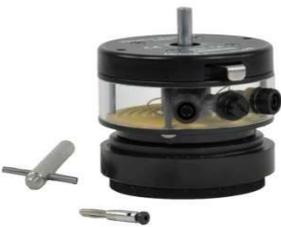
Zur Erzeugung mechanischer Schwingungen in Verbindung mit einem Funktionsgenerator; horizontal gelagerter Lautsprecher, geschützt jedoch sichtbar montiert in geschlossenem Acrylglasgehäuse, zentrale Metallachse mit 4-mm-Bohrung zur Aufnahme verschiedener Aufsätze, mechanische Arretierung der Achse zum sicheren Wechseln von Aufsatz-Zubehör, zwei 4-mm Sicherheitsbuchsen; inkl. Schnurhalter mit 4-mm-Steckerstift,
