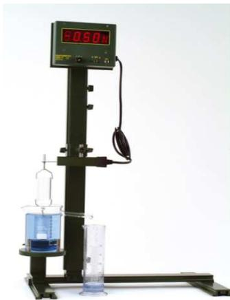
Magnethaftendes Demo-Messinstrument zur Messung von Kraft (Newton) oder Masse (Gramm). Die weithin sichtbare LED-Anzeige (H=26 mm) und der externe Sensor in robustem Vierkant-Rohr-Gehäuse ergeben ein optimales Instrument für Mechanik-Experimente, vor allem auf der Haftarbeitsfläche. Es können sowohl Zug- als auch Druckkräfte gemessen werden. Der Sensor ist durch eine Stativstange D=10 mm an üblichem Stativmaterial fixierbar.
