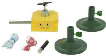
Tischaufbau - Geräteset zur Erzeugung stehender Transversalwellen, mit eindeutiger Erkennbarkeit von Knoten und Bäuchen und der Veränderung der Anzahl dieser bei unterschiedlicher Erregerfrequenz.
