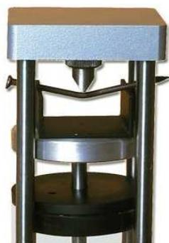
Acrylglasmodell zur Demonstration der hydraulischen Kraftübertragung; mit diesem Modell können nicht nur die Bewegung des Pump- und des Presskolbens sowie das Ventilspiel gezeigt werden, sondern tatsächliche praktische Anwendungsbeispiele vorgeführt werden. Das Flächenverhältnis der beiden Kolben von 1:12 und die robuste Bauweise erlauben eine nutzbare Kraftwirkung von bis zu 500 N! Kolben-Di=16 mm bzw. 56 mm
