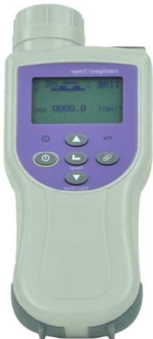
Kompakte, intelligente Zeitmesseinheit; durch die exakte 0,1 ms- Auflösung und eine einfach bedienbare Menüführung mit Speichermöglichkeiten sind Experimente zur Bewegungslehre einfach mess- und berechenbar; mit Gabellichtschranken und Speichenrad können auch Resultate für Geschwindigkeit und Beschleunigung angezeigt werden;
