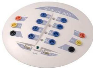
Das anwenderfreundliche Laborgerät für Lehrer und Schüler. Messen und Steuern in Echtzeit oder nach Voreinstellung auch PC-unabhängig verwendbar (z.B. für Langzeitmessungen). Ermöglicht die Verwendung von bis zu 6 Sensoren gleichzeitig, bei einer Abtastrate von bis zu 100.000 Messungen pro Sekunde. Integrierter Speicher (Cache) für Datensicherheit bei Echtzeitmessungen.
